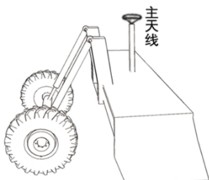
单控平地机 (高精度卫星天线装在铲子中央)
