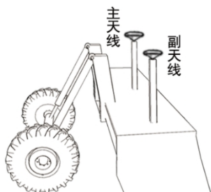
双控平地机 (主副天线装在两端)
